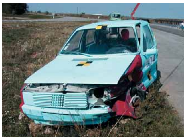
Figura 2 - Deformazione autoveicolo TB11
